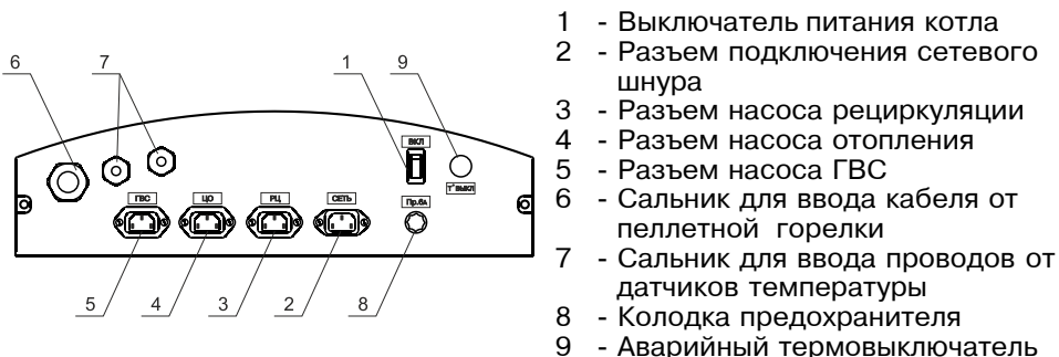
Рис.6 Расположение органов управления на задней панели пульта
